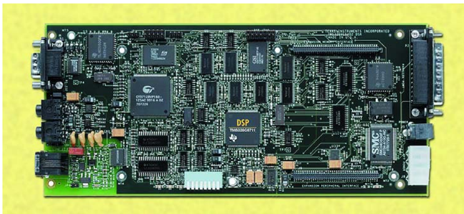
La carte DSP avec le processeur de signal TMS320C6711 de Texas Instruments.
