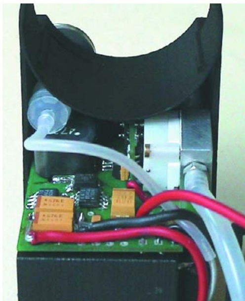
Figure 5. Système d'éléments à combustible pour caméscope (éléments empilés, électronique, micro-vanne, régulation de mise en marche).
