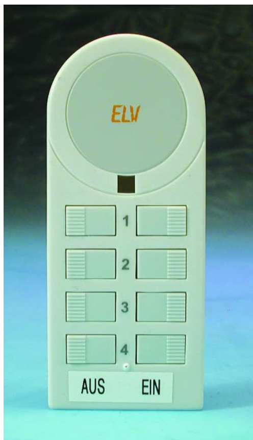
Figure 1. L'émetteur manuel (ELV FS 10 S8-2) avant sa modification.
