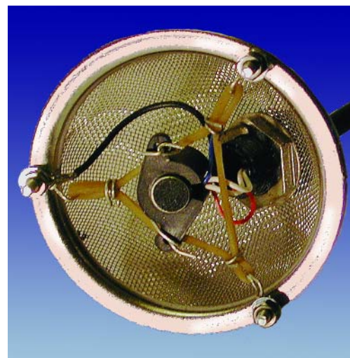
Figure 4. Les capsules de microphone sont fixées par des bandes élastiques.
