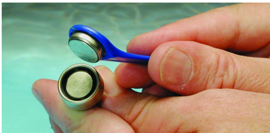
Figure 1. Un iButton du type DS9092 avec sa sonde de lecture.
