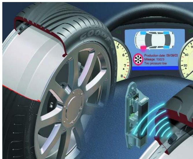
Figure 3. Un avenir sans pile : interrogation basée sur le principe d'un système RFID. (Siemens-Goodyear)
