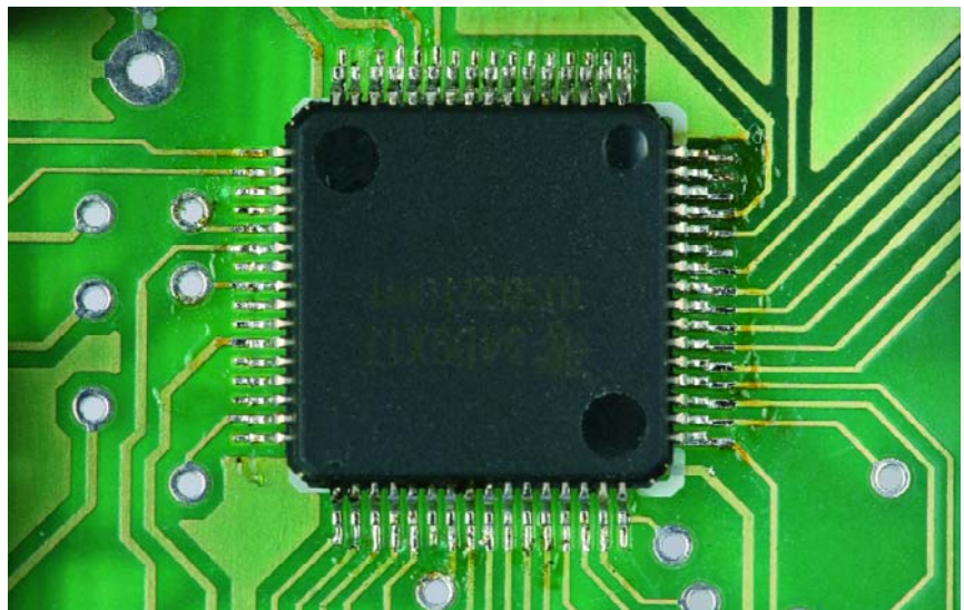
Figure 6. Miniature et épouvantable (à souder) : le contrôleur USB en boîtier SPFP à 64 pattes.
