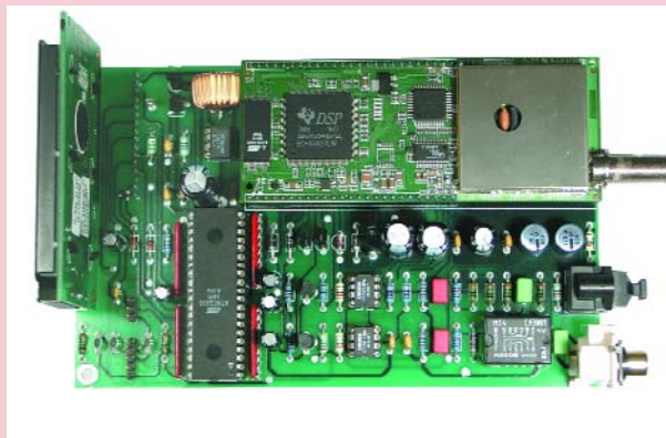
Au coeur du tuner DAB de la série « Audio Mini Modul » de Restek ( www.restek.de ).
