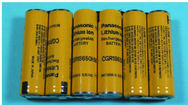
Figure 5. Accu Li-Ion pour PC portable en version 3S2P (tension de bornes de 10,8 V).
