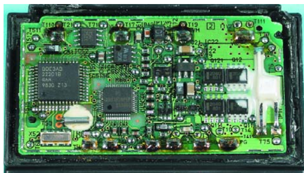
Figure 2. Les circuits de surveillance intégrés dans les accus au lithium industriels sont pour la plupart pilotés par micro-processeurs.
