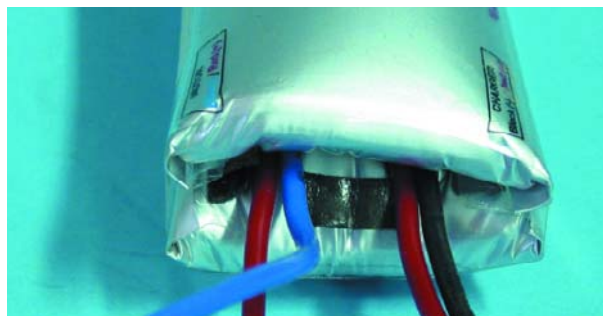
Figure 1. Lorsqu'un LiPo se gonfle c'est qu'il est défectueux et risque, à l'extrême, d'exploser.
