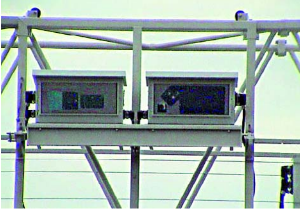
Font déjà partie de la vie quotidienne sur l'autoroute : ponts de contrôle avec détecteurs destinés à saisir les données de péage. (Cliché : Toll Collect)
