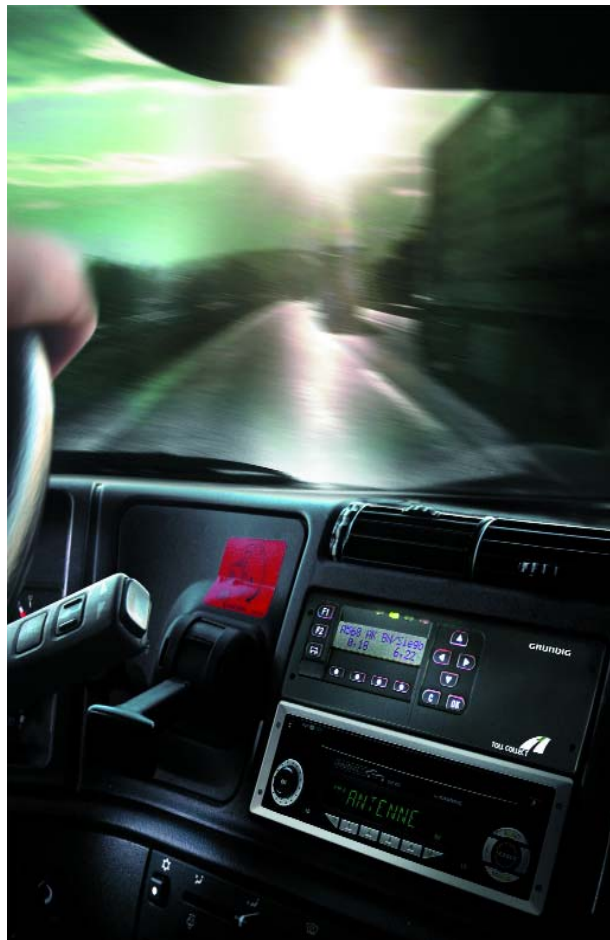
Figure 1. Appareil du véhicule ( On-Board Unit , OBU) pour l'enregistrement automatique sur les tronçons à péage. Il contient les données propres au véhicule que le conducteur peut mettre à jour (par exemple lorsqu'il roule sans remorque). (Cliché : Grundig)
