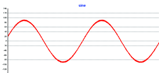
Figure 2. Forme d'onde du signal sinus à la sortie de la carte-son (2 kHz)
