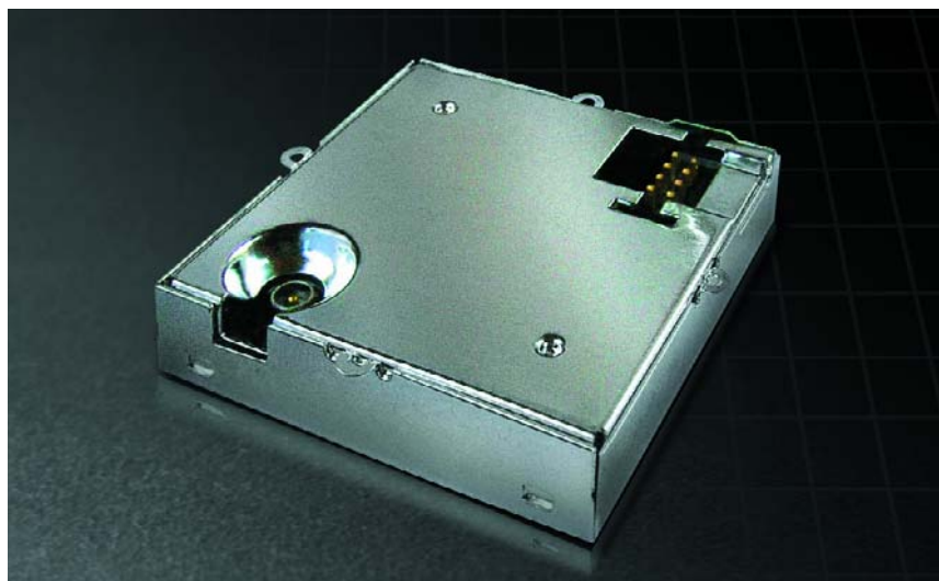
Figure 1. Le module GPS a la taille d'un timbre-poste et est à peine plus épais.
