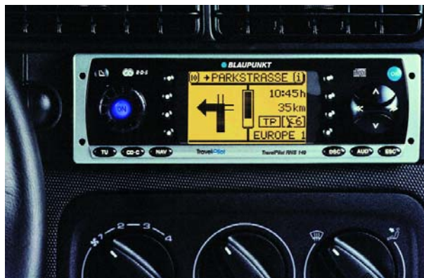
Figure 1. TravelPilot RNS 149 de Blaupunkt est un autoradio équipé d'un lecteur de CD et d'un système de navigation. Il peut être monté dans l'emplacement DIN standard de n'importe quel véhicule de type courant. (Blaupunkt)
