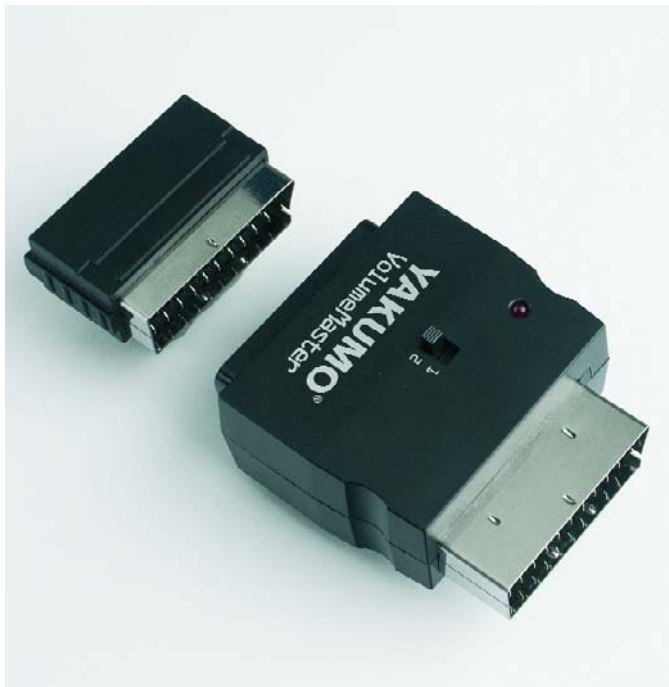
Figure 1. Les entrailles du Volume Master. L'embonpoint est resté faible de sorte que l'on peut mettre l'électronique dans un boîtier à la forme d'adaptateur. Les CMS se trouvent sur le dos de la platine.
