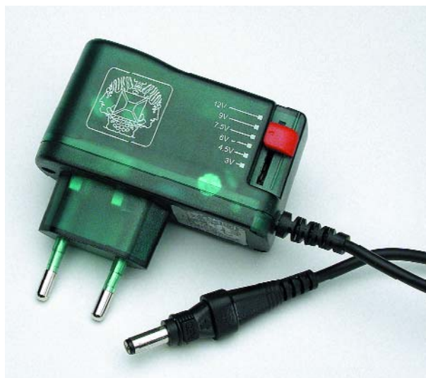
Figure 2. Une alimentation à découpage est moins encombrante et plus économique qu'une alimentation linéaire.
