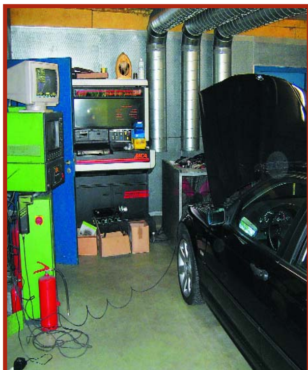
La BMW est reliée au cordon ombilical du banc à rouleaux.
