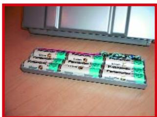
ment la densité énergétique qui passe à 620 Wh/l. Le pack d'accus comportait neuf cellules individuelles en colonnes par trois. Matsushita compte améliorer encore la puissance par cellule qui est actuellement de 2 900 mAh, soit plus de 26 Ah (la moitié de la puissance de certaines batteries de voiture) pour le pack complet.
