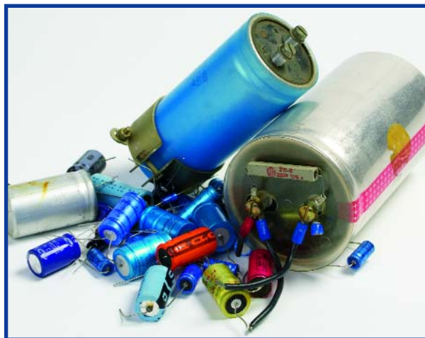
Figure 3. Les condensateurs électrolytiques sont un des cas épineux dans l'élimination des déchets. Les exemplaires les plus anciens peuvent aussi contenir des substances suspectes comme des PCB (biphényles surchlorés).
