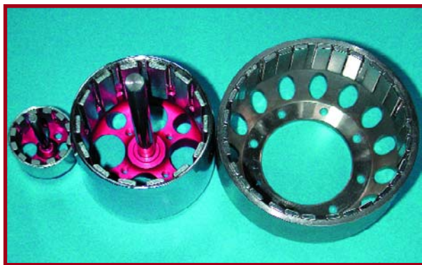
Figure 12. La distance entre les aimants des machines multi-pôles – ici un moteur à induit extérieur – ne devraient pas être trop faibles. À droite, un rotor 10 pôles dans lequel 3 bandes magnétiques réunies forment un pôle.
