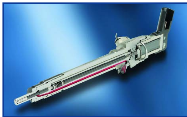
Figure 2. La soupape de pompe d'injection diesel entraînée piézoélectriquement. Le piézo-actuateur gris à droite pilote l'aiguille de la buse. (Illustration : Siemens VDO)
