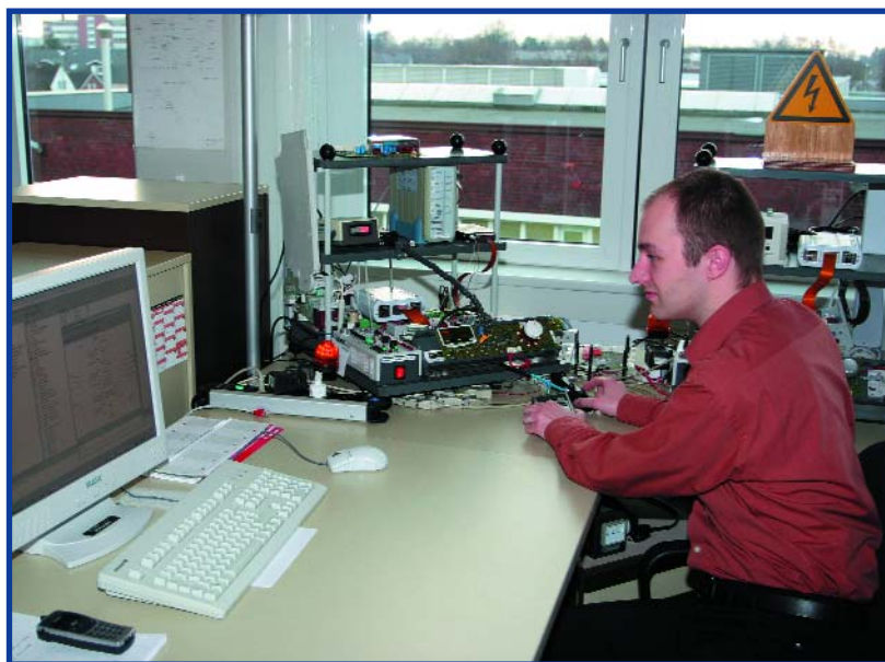
Figure 4. Le concepteur de logiciel Andreas Lux teste un module de programme à l'aide d'un « poste d'émulation ». Une pompe refoulante simule la montée de l'eau dans la machine à laver.
