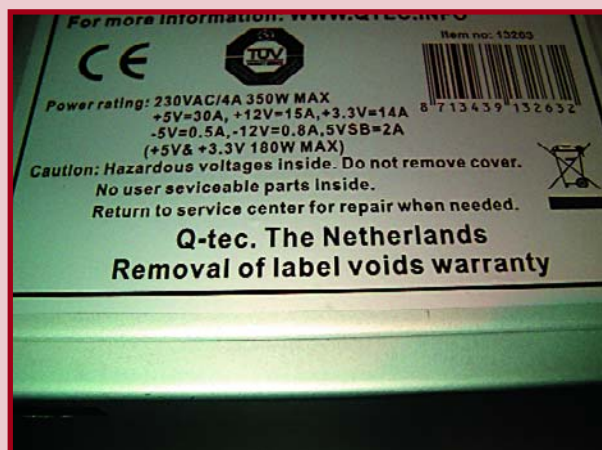
2. 15 A sur la ligne 12 V; ceci signifierait que l'on dispose de 180 watts de puissance pour notre éclairage halogène.
