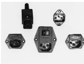
Figure 3. Fiche et embases d'entrée secteur de châssis.
