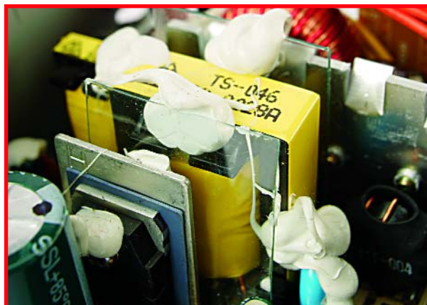
Figure 10. Écrans plastiques intercalés entre le transfo et les radiateurs.
