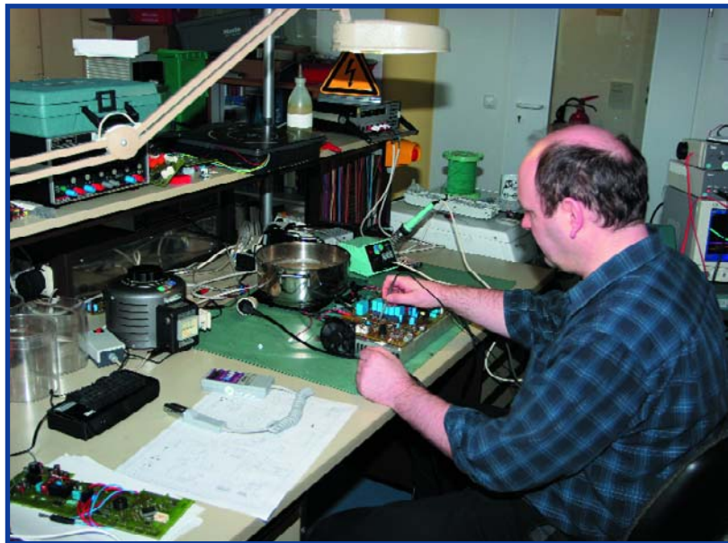
Figure 3. Avec son poste de soudage, son transformateur réglable et son oscilloscope, la place de travail du concepteur de composants Martin Schulze-Hobeling ne diffère pas beaucoup de celles qu'on trouve dans de nombreux autres laboratoires. Seule la casserole révèle qu'il s'agit d'électroménager.
