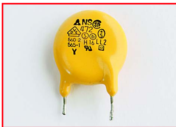
Figure 11. Un condensateur Y doté de tous les « sacrements ».
