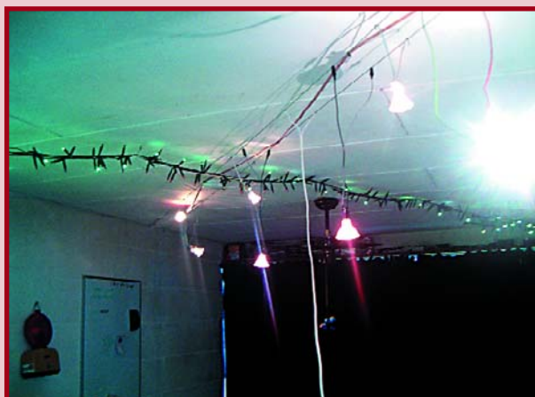
9. La crête de courant produite par autant d'ampoules peut présenter une amplitude importante.
