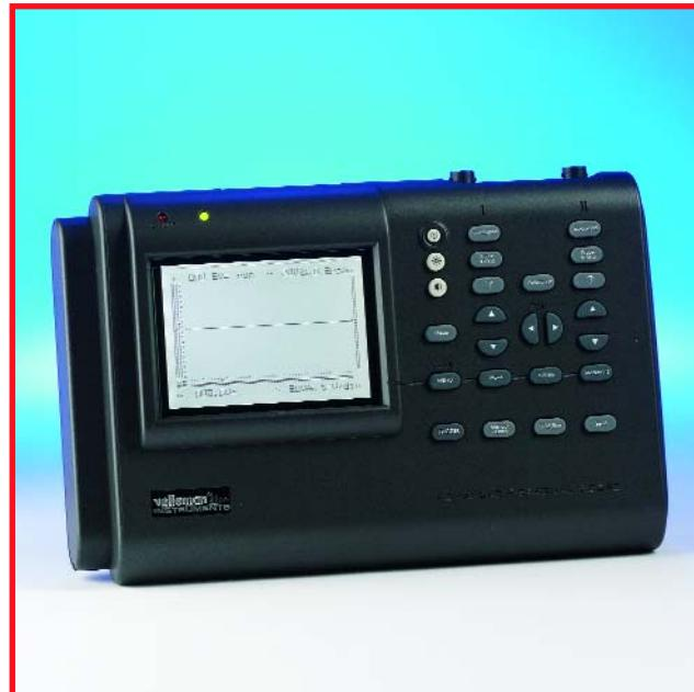
Metex a mis une paire de scopemètre à notre disposition, dont le MS-2000. Cet « Handy-scope » est un instrument de mesure 1 voie utilisable également en multimètre, sonde logique ou fréquencemètre (5 chiffres) dont la plage de mesure s'étend jusqu'à quelque 10 MHz. La partie oscillo n'en impose pas vraiment par ses spécifications. La fréquence d'échantillonnage n'est que de 10 Mé/s. Rien d'impressionnant.
