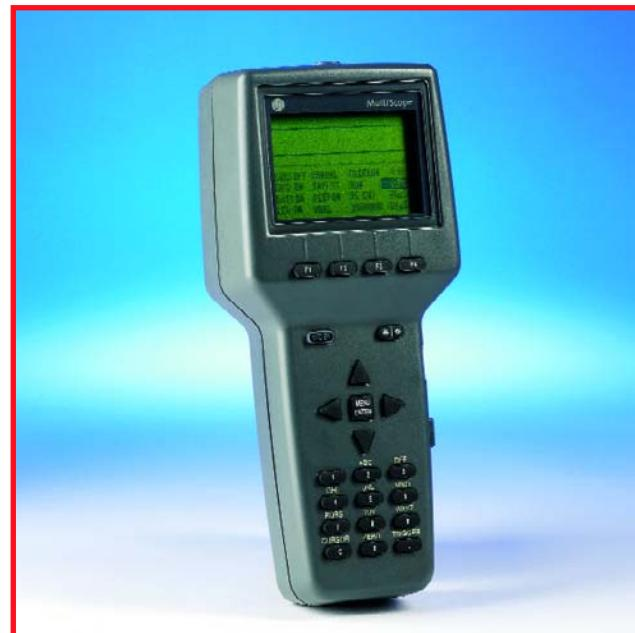
À l'image du HPS40 de Velleman, le Multiscope est un instrument relativement simple quant à ses spécifications, ce qui en limite l'utilisation. Il s'agit cependant d'une version 2 voies; il est livré avec mini-valise plastique, chargeur/adaptateur, 2 sondes, câble RS-232 et logiciel PC sur CD-ROM pour transfert sur PC des mesures relevées. Le taux d'échantillonnage est de 20 Mé/s par canal. L'alimentation peut se faire à l'aide de 6 piles AA.
