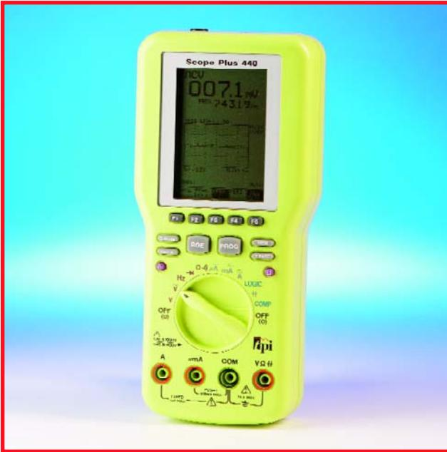
Ce scopemètre n'est pas en fait destiné aux applications en électronique. Comme le dit Merconet lui-même, c'est un « qualimètre d'alimentation secteur » à utiliser principalement pour le test de tensions secteur dans les habitations et bâtiments industriels. Le taux d'échantillonnage n'est pas moins de 20 Mé/s. Il est également possible de visualiser sur l'oscillo les caractéristiques tension/courant de divers composants électroniques.
