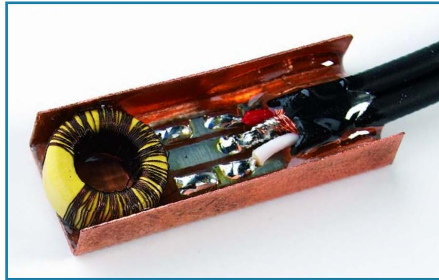
**Figure 3.** Voici comment réaliser le capteur. L'enclos de cuivre le protège efficacement contre l'influence de parasites.
