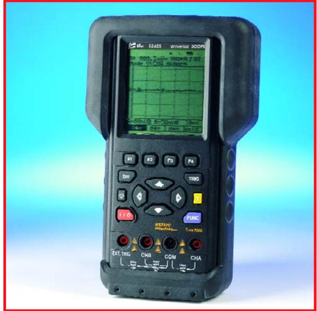
Le Seintek S2405 est le « grand » frère du S2401. Il s'agit d'un appareil relativement simple, ce qui est aussi le cas des spécifications. La fréquence d'échantillonnage est de 25 Mé/s en mode 2 voies et de 50 Mé/s en mode mono-canal. S'il est correct, ce taux d'échantillonnage est limite, pour le moins, pour des mesures sur, par exemple, un signal vidéo. Ces spécifications conviennent à des mesures simples sur des signaux audio ou autres tensions « ne grimpant pas trop en fréquence ».
