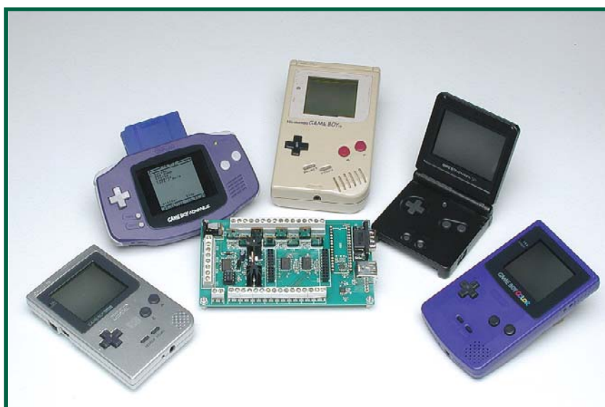
Figure 1. Modèles de Game Boy utilisables. N'importe lequel, hormis les modèles DS et la Game Boy Micro. Elles entourent la platine de l'interface I 2 C que pilote la Game Boy dotée du module GBDS.
