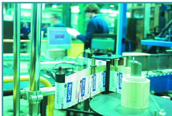
Figure 2. Inlays d'étiquettes au mètre. Un « inlay » se compose d'une puce, d'un enroulement d'antenne et du matériau de support (papier ou film plastique).
