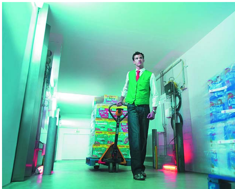
Un collaborateur du groupe commercial Metro fait passer une palette de couches par un portique à lecteur RFID qui lit les données de la puce à la vitesse de l'éclair. À gauche et à droite (visible sur le côté droit), les antennes du lecteur RFID (photos : Philips).
