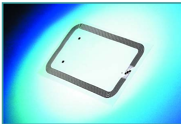
Figure 1. Étiquette RFID avec antenne et puce.
