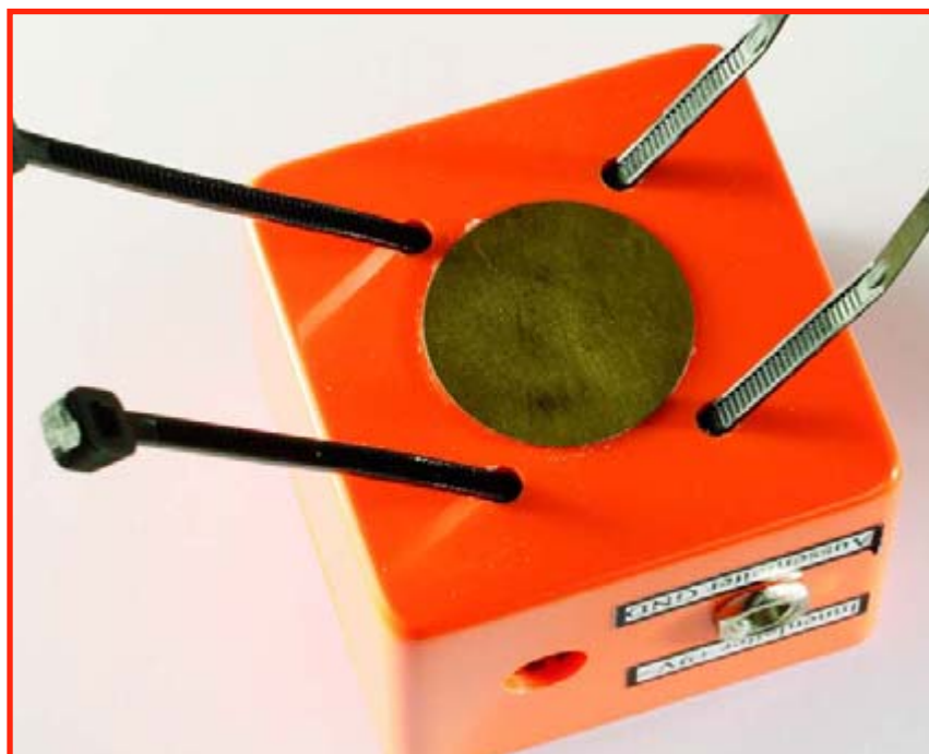
Figure 2. Le boîtier avec le capteur collé à plat est fixé fermement au tuyau d'eau chaude par 2 attaches de câble.
