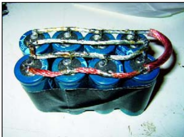
Ainsi donc. Le câble pour haut-parleur a été dénudé et bien étamé aux endroits où seront soudés les condensateurs.
