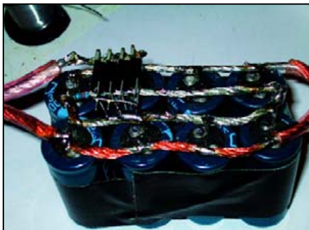
Les FETMOS. Ne voulant pas nous trouver confrontés à des platines mutilées, nous avons câblé le prototype « en l'air » au-dessus des condensateurs.
