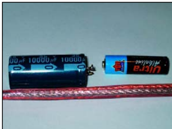
L'acteur principal : le condensateur. Il s'agit d'un exemplaire de 10 000 \mu\text{F} . Nous en interconnectons 8 à l'aide de morceaux de câble pour enceintes (la pile, AA sert uniquement de référence).
