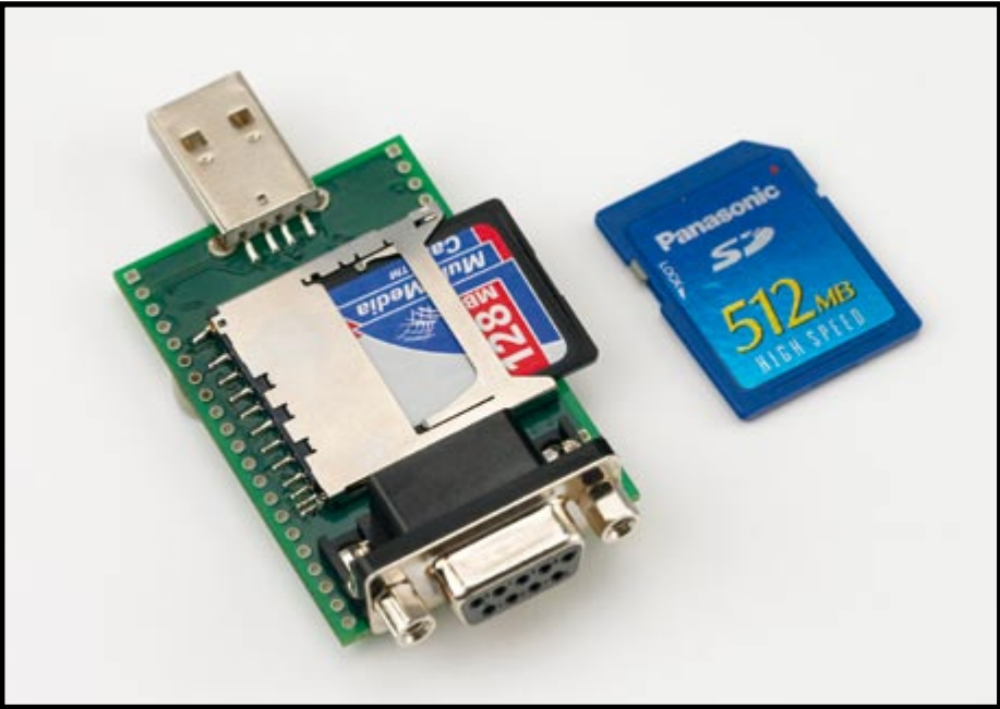
Figure 3. Le dessus de la platine ne comporte que 3 composants : l’embase USB, l’embase RS-232 et le connecteur de carte MMC/SD.
