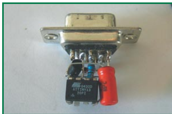
Ici, dessiner une platine revient à perdre de la place. En outre, cette technique de montage en l'air fait bien plaisir.
