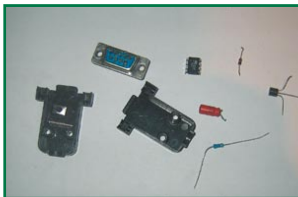
5 composants électroniques, un connecteur Sub D 9 points, son capot et un rien de fil de liaison, il n'en faut pas plus pour réaliser ce montage.
