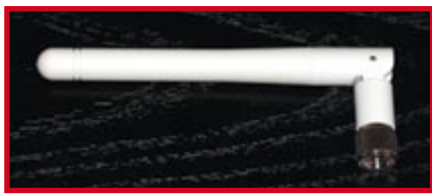
Figure 3. Antenne-moignon quart d'onde d'un routeur-WLAN ou Access point.
