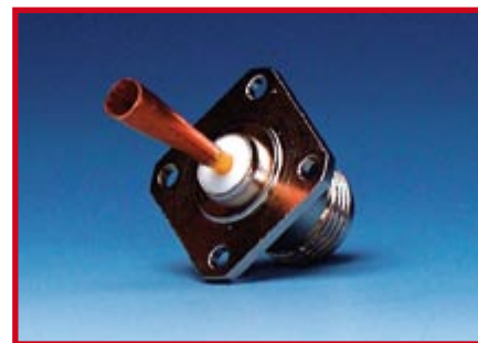
Figure 8. Douille N avec le radiateur soudé, conique en tôle de cuivre.
