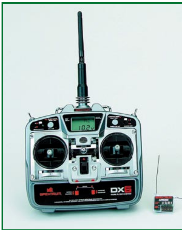
Figure 2. Émetteur 2,4 GHz DX6 pour aéromodélisme avec récepteur à 6 fonctions d'asservissement (Figure : Graupner [6]).
