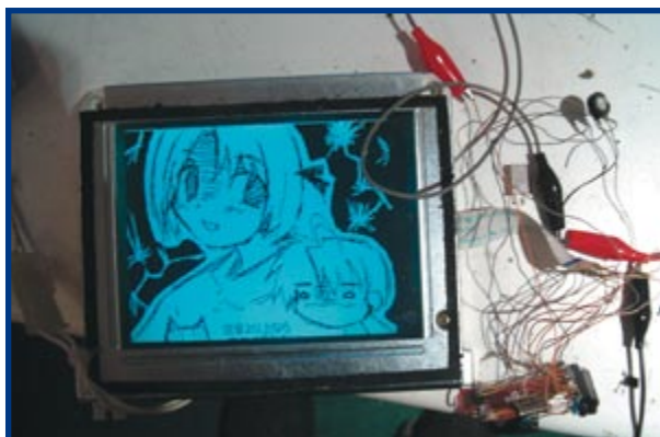
Le système devrait fonctionner du premier coup. Ce prototype se compose de beaucoup de fils autour d'un afficheur de 320x240 pixels éclairé par l'arrière.
