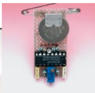
Figure 2 - Placez les composants aussi près que possible l'un de l'autre sur une pla- quette perforée, pour former un ensemble compact.
