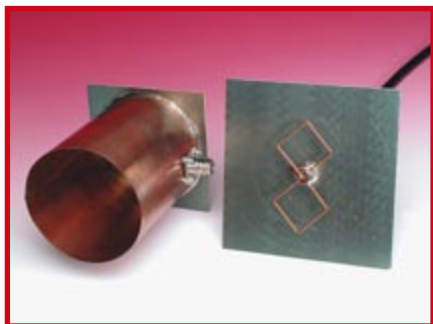
Figure 4. Prototypes d'antennes Cantenna et BiQuad réalisés au laboratoire Elektor.
