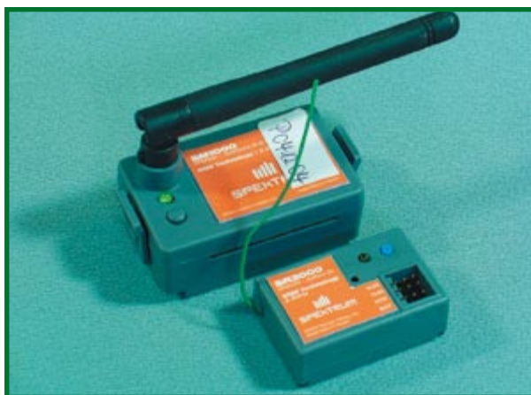
Figure 3. Module HF d'émission et récepteur pour la télécommande de modèles de voitures (Photo : Dieter Perkuhn).
