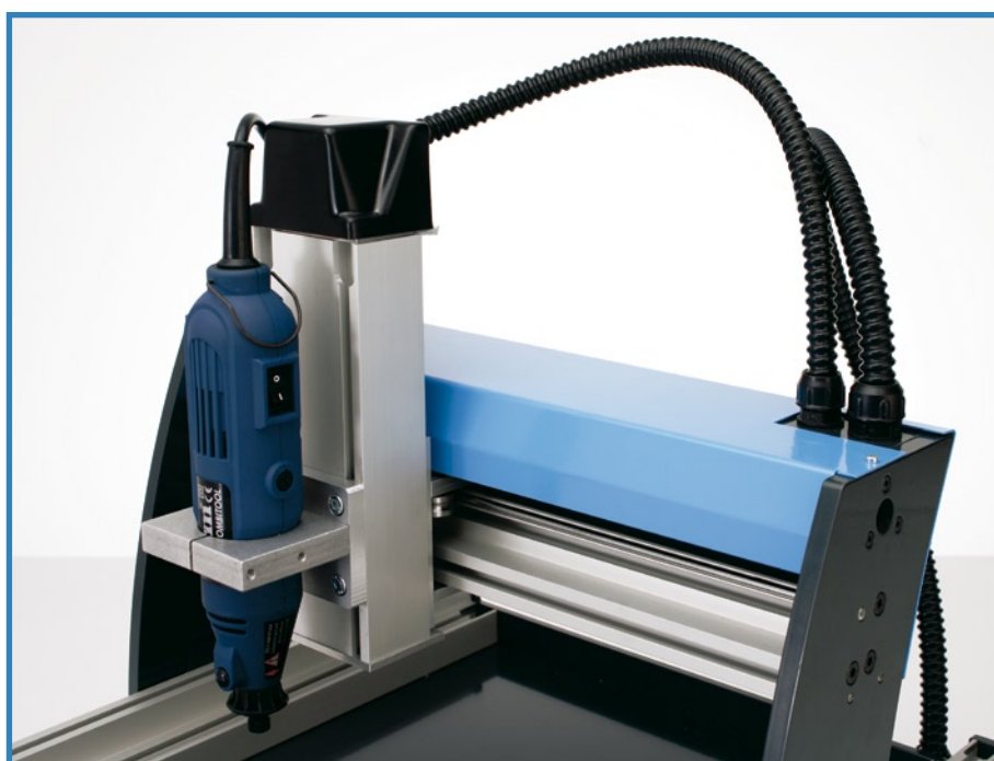
Figure 5. La colonne de perçage avec le guidage dans le portique.
