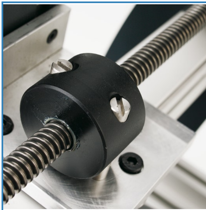
Figure 4. Détail de l'écrou en plastique avec les broches transversales qui permettent une transmission sans jeu.
