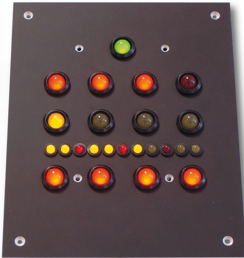
Figure 2. L'afficheur de la version proposée ici n'utilise pas de lampes, mais des LED.
