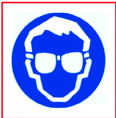
Figure 4. Dotez votre insolateur de ce symbole de danger, requérant le port de lunettes de protection UV. L'intensité importante des LED UV peut endommager la vue.
