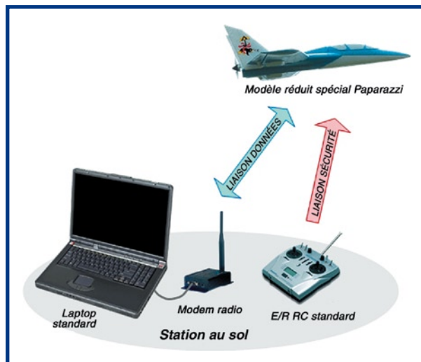
Figure 1. La station au sol d'un « Open source UAV » est constituée par un ordinateur portable avec modem radio et une radiocommande de type usuel pour modèle réduit comme remplacement de secours du pilote automatique. (Illustration Paparazzi/ENAC)
