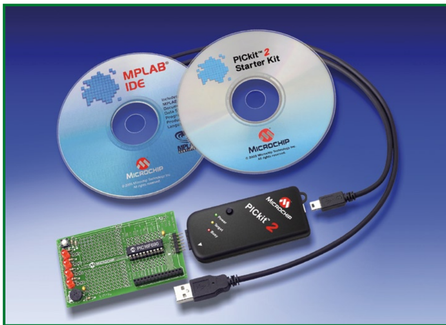
Figure 2. Le PICkit2 est un kit dans un kit au potentiel très intéressant pour tous les utilisateurs de PIC vu qu'il comporte et un débogueur et un programmeur.
