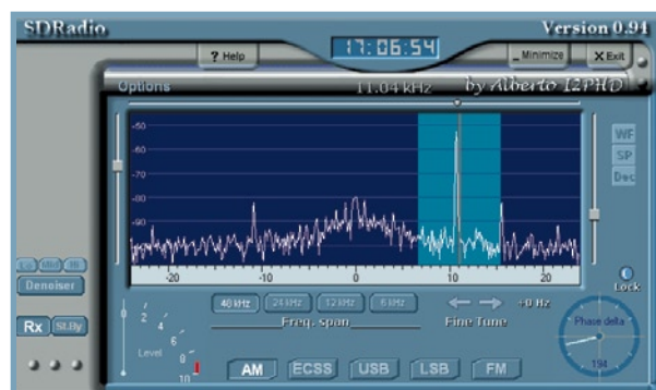
Figure 8. Fréquence-image amortie avec deux mélangeurs.
