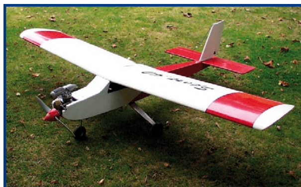
Albatross, un UAV (Unpiloted Aerial Vehicle ou avion robotisé) à aile fixe dû au génie des néo-zélandais John Stowers et Hugo Vincent [12].
