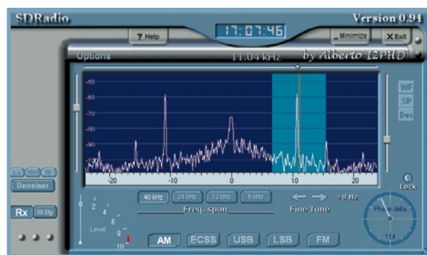
Figure 7. Fréquence-image avec un seul mélangeur.
