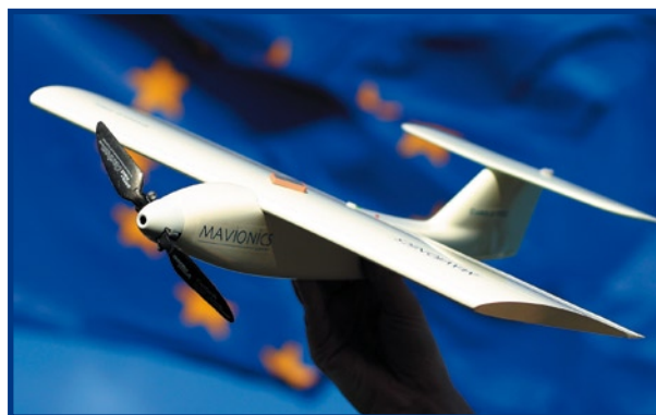
Figure 2. Le Caro P50 est un avion miniature pouvant voler de façon totalement autonome : son envergure ne dépasse pas 49 cm (Photo : Hanns-Walter Schulz)
