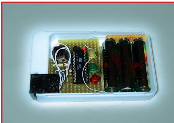
Tout s'adapte convenablement. Le bloc noir à gauche, c'est le connecteur UTP.
