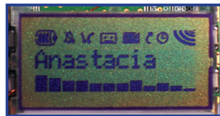
Figure 8. Affichage sur l'écran LCD du nom de l'interprète et de l'analyseur de spectre de WinAmp.
