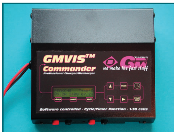
Figure 7. Le chargeur de Graupner permet une charge I/U (à courant constant/tension constante) avec un courant de charge limité à 9,2 A et une tension de charge maximale de 3,6 V/cellule.
