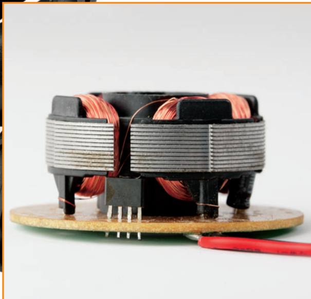
Figure 2. Générateur de champ tournant est peut-être exagéré : l'ensemble de l'électronique, y compris le capteur Hall, sont intégrés dans un circuit à 4 pattes. Il faut y ajouter un condensateur électrochimique.
