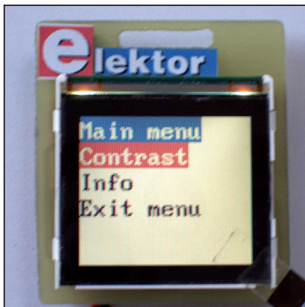
Figure 8. L'AVR commande même le réglage du contraste.
