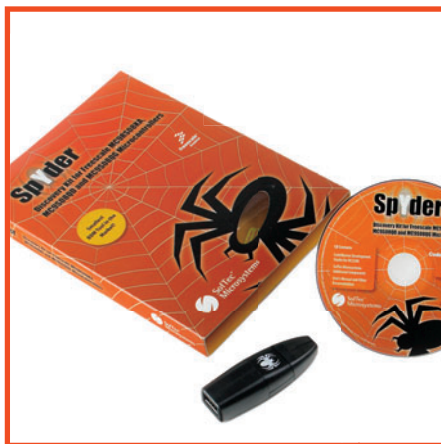
Figure 1. Le Kit SpYder Discovery dans sa récente métamorphose (le mois dernier, nous vous en avions présenté la version bêta). À la faveur d'un arrangement spécial avec Freescale Semiconductor, vous pouvez acheter l'ensemble auprès d'Elektor au prix d'à peine 9,75 euros (+ frais de port et d'emballage) Notez qu'il faut vous procurer ou fabriquer vous-même le câble en nappe BDM à 6 conducteurs.
