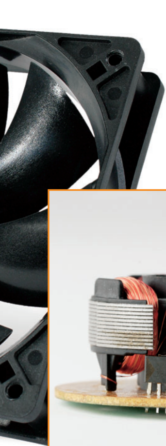
Figure 2. Générateur de champ tournant est peut-être exagéré : l'ensemble de l'électronique, y compris le capteur Hall, sont intégrés dans un circuit à 4 pattes. Il faut y ajouter un condensateur électrochimique.
