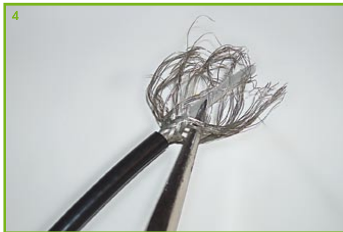
En vous servant de l'outil pointu démêlez soigneusement les filaments constituant la tresse.
