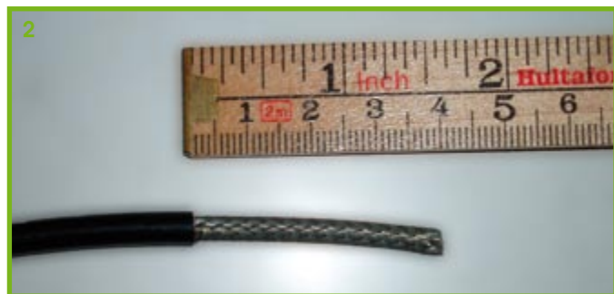
Coupez quelque 40 mm de la gaine d'isolation extérieure. Vous verrez apparaître la tresse métallique servant de blindage du câble.
