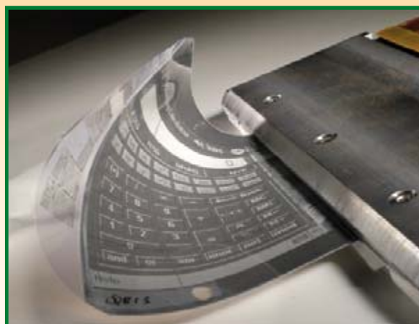
Figure 5. Écran souple « Polymer Vision » s'appuyant sur la technique OLED. La résolution est de 320 x 240 pixels (QVGA), la diagonale de 5 pouces (12,7 cm) et le rayon de pliage de 2 cm (photo: Philips).
