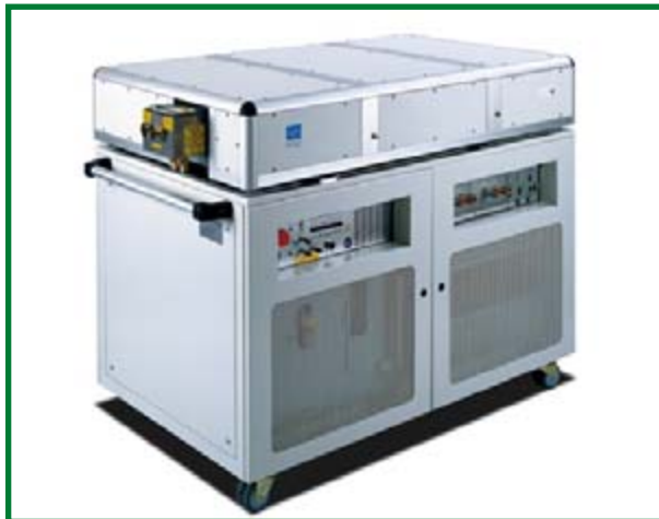
Figure 10. La source laser RVB de 2 ème génération s'appuie sur un laser à solide à pompage optique à diode qui produit les trois longueurs d'onde monochromatiques de 628 nm (rouge), 532 nm (vert) et 446 nm (bleu). Des modulateurs acousto-optiques impriment à la lumière laser les informations visuelles telles que la luminosité et la couleur. Toutes les informations visuelles sont transmises comme faisceau de lumière parallèle (photo: Jenoptik LDT).
