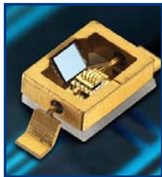
Figure 2. Osram présentait à Munich un mini-laser de puissance CMS (Photo : Osram OS).
