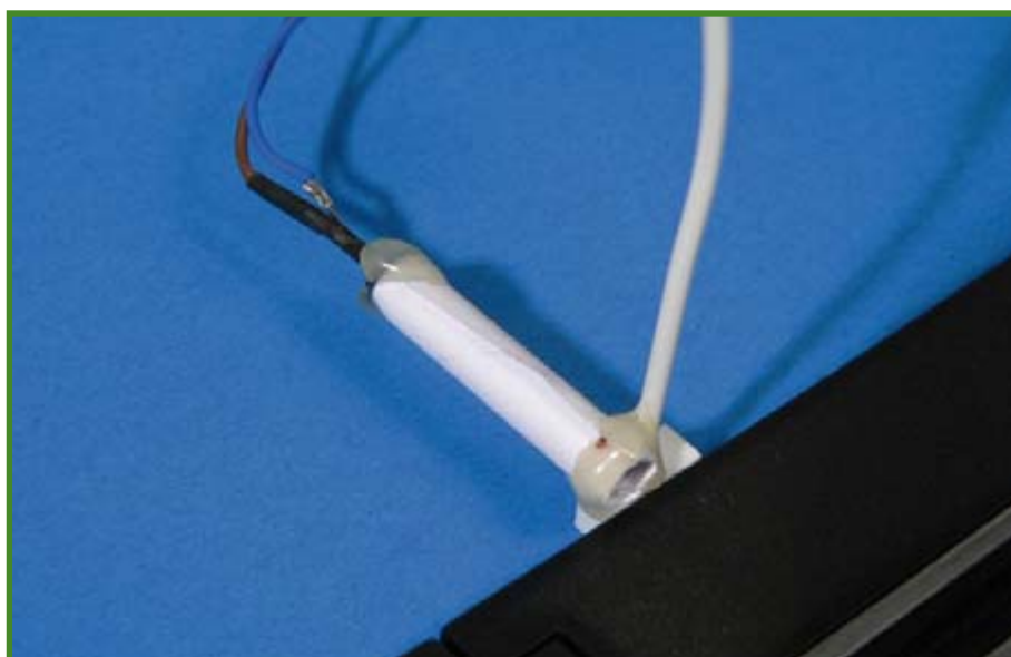
Figure 4. L'un des phototransistors emballé, dont au moins un des fils a été isolé, a trouvé sa place, fixé à l'aide de colle thermique.
