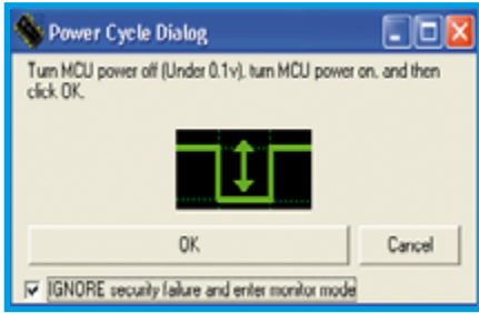
Figure 9. Quand apparaît la fenêtre Power Cycle Dialog, la tension d'alimentation doit être interrompue brièvement puis rétablie.
