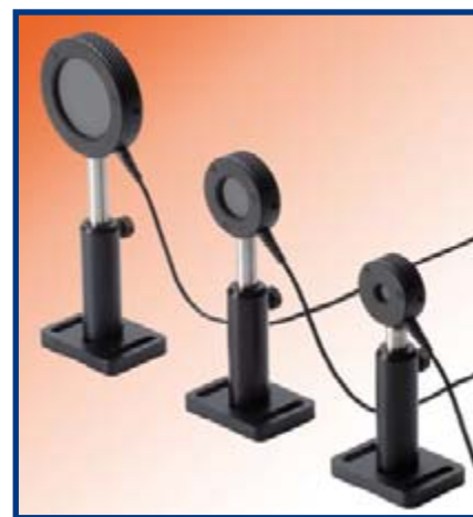
Figure 3. Les capteurs de mesure d'impulsions laser couvrent une plage de longueurs d'ondes allant de 0,19 \mu m à 12 \mu m. La puissance varie entre 300 nJ et 2 J (Photo : Coherent).
