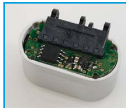
Figure 3. On repère le convertisseur-élévateur parmi les composants montés en surface.
