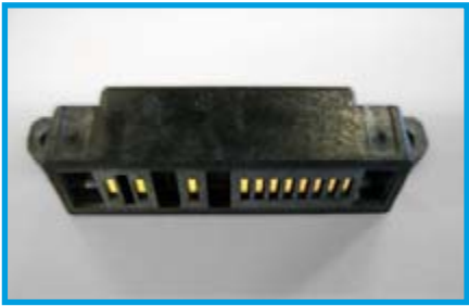
Figure 6. La programmation passe par la rangée de contacts du téléphone portable. On trouvera aussi sur l'Internet le connecteur représenté.
