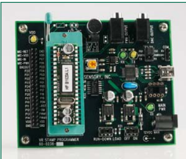
Figure 1. Le VR Stamp™ Toolkit est en fait une carte-mère dans laquelle est implanté le module gigogne, un VR Stamp™ Module.
