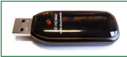
Figure 7. Un lecteur de cartes bon marché fournit, après démontage, le connecteur de carte SD nécessaire.
