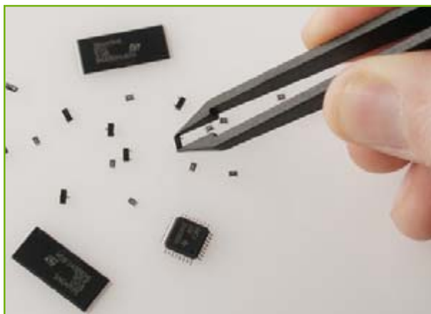
Figure 3. Les brucelles antistatiques spéciales pour CMS sont d'un prix abordable et ne finiront pas facilement dans la trousse de maquillage de Madame.
