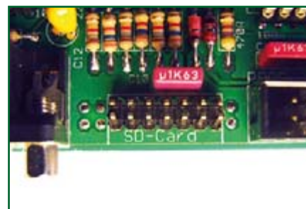
Figure 5. Si l'on veut pouvoir coincer une carte SD entre les contacts de l'embase, les deux rangées de broches de cette dernière sont rapprochées jusqu'à 1,5 mm l'une de l'autre.
