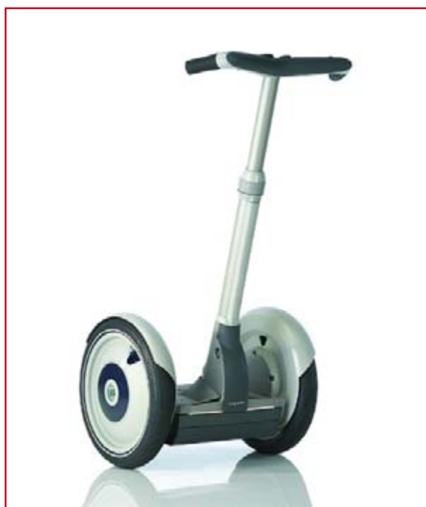
Figure 1. Les transporteurs personnels électriques genre Segway ne peuvent pas être maîtrisés sans l'aide d'un gyroscope.
