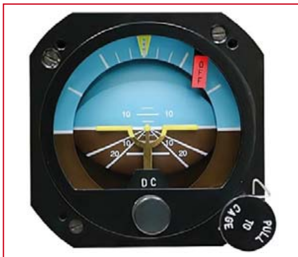
Figure 3. L'horizon artificiel dans la cabine de pilotage d'un avion contient un gyroscope dans une suspension à la Cardan. La rotation est assurée pneumatiquement ou électriquement.
