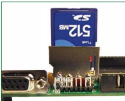
Figure 9. Les contacts de l'embase n'ayant pas de fonction sont, pour garantir une meilleure stabilité, soudés à la tôle de protection du connecteur de cartes SD.
