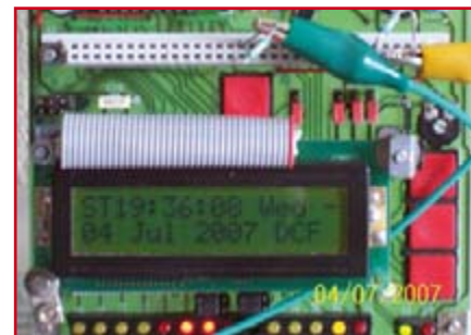
Figure 2. Présentation de l'heure, de la date et du symbole de réception DCF (sur la mono-carte PICÉE).
