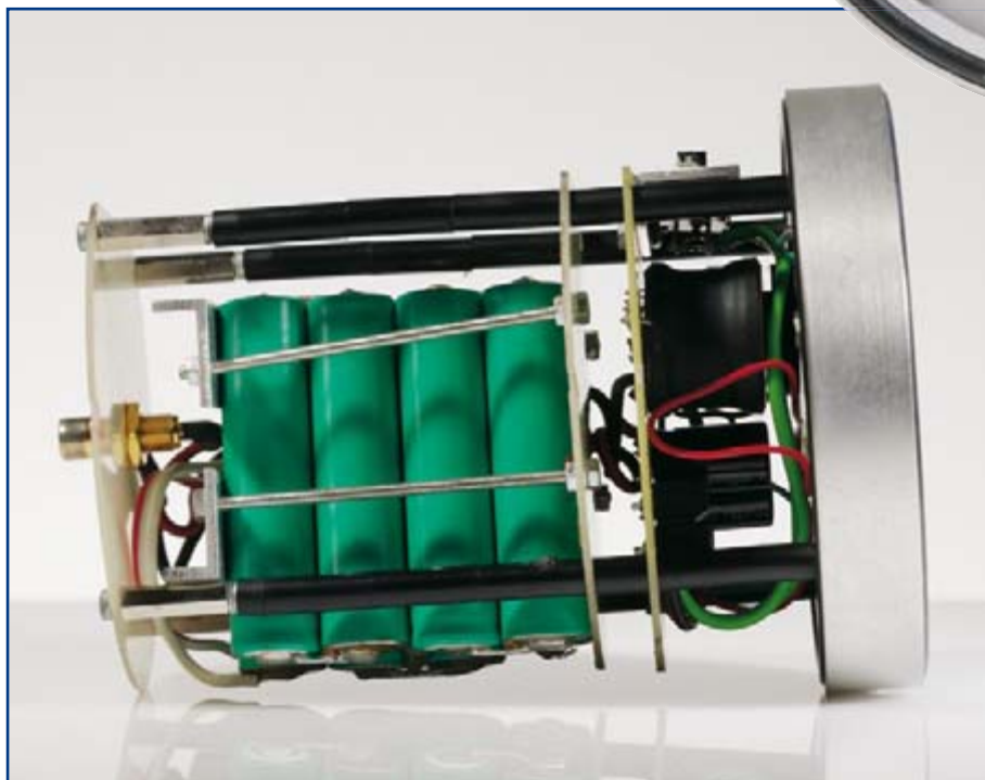
Figure 4. Quelques entretoises et vis de bonne longueur permettent de réaliser un ensemble solide à implanter dans le corps de la lampe-torche.
