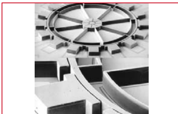
Figure 8. Anneau à suspension élastique servant de masse de référence dans un micro-gyroscope.
