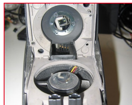
Voici où prend place la lampe. Sous elle on remarque un des trois ventilateurs qui assurent son refroidissement. Vers l'arrière, l'orifice rond débouche sur la roue colorée et le système de condensation (noir).
