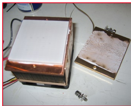
Le refroidisseur Peltier. Après enlèvement de la semelle métallique, on a accès à la couche céramique qui peut entrer en contact direct avec les LED.
