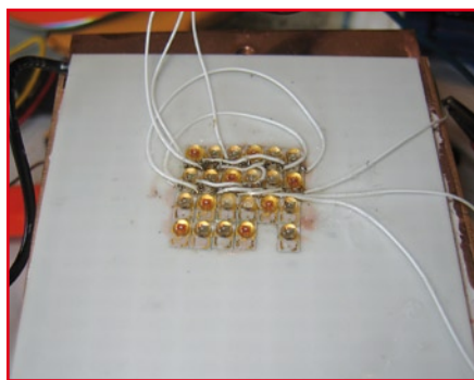
Câblage de la première moitié des LED au moyen de fil wire-wrap au Kynar. On peut éventuellement rigidifier le câblage au moyen de colle instantanée mais dans ce cas, plus question de réparer facilement.
