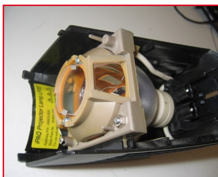
Cette fameuse lampe, fragile et onéreuse, que nous nous efforçons de remplacer par des LED.
