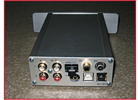
Figure 1. Le convertisseur offre une possibilité simple de doter un convertisseur N/A d'une entrée USB (ici, l'un des appareils de l'auteur, cf. [1]).
