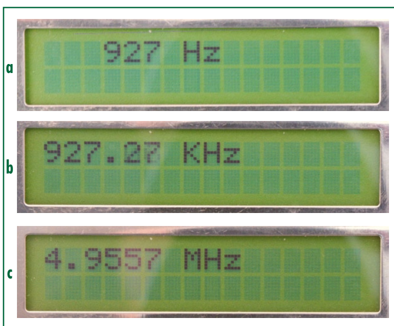
Figure 4. Le contenu de l'affichage alterne automatiquement entre Hz (a), kHz (b) et MHz (c) selon la fréquence.
