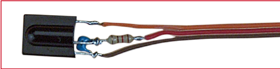
Figure 5. TSOP avec filtre RC (résistance + condensateur) et ses lignes de connexion.
