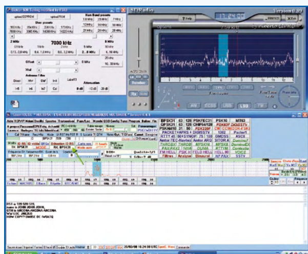
Figure 5. Réception en mode BPSK31 (flèche verte) mettant en oeuvre les mêmes programmes que ceux de la figure 4.
