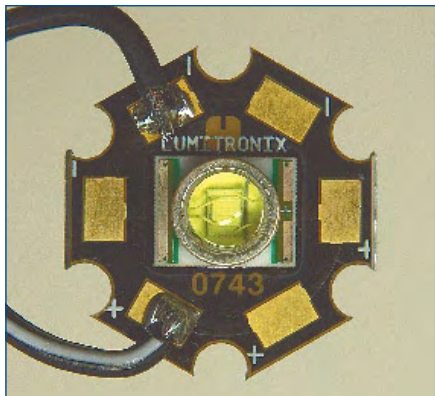
La LED de puissance 3 W de Cree avec dissipateur thermique est aussi un composant électronique très esthétique.
