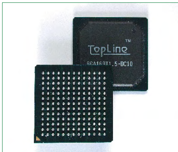
Figure 8. Un composant en boîtier BGA (Ball Grid Array) ne comportant « que » 169 points de soudure.
