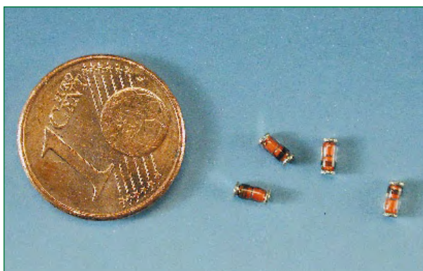
Figure 4. Diodes sans fils : Le boîtier CMS cylindrique MELF est dérivé du modèle à fils.
