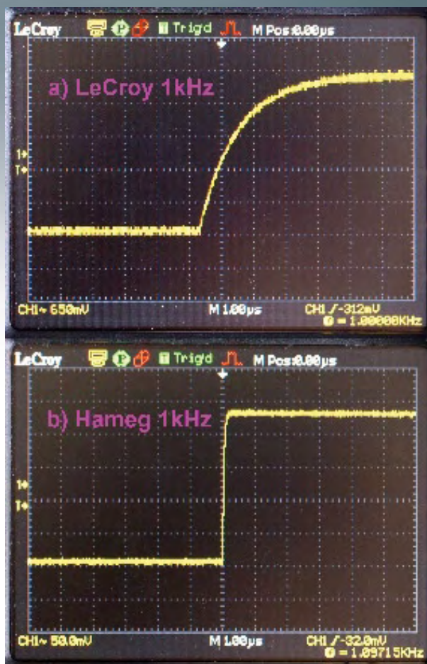
Figure 3. Le signal carré à 1 kHz pour la compensation de sonde de LeCroy (a) n'est pas aussi bien défini que celui d'un vieux Hameg (b).
