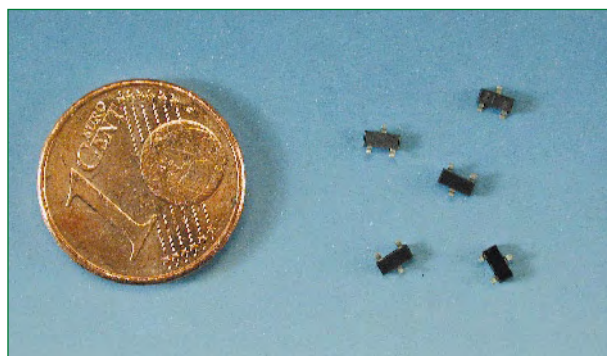
Figure 6. Le boîtier des transistors CMS et des petits circuits intégrés est encore équipé de courtes pattes latérales.
