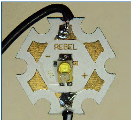
Le « Rebel » de Luxeon est particulièrement petit et est équipé d'un support céramique.
