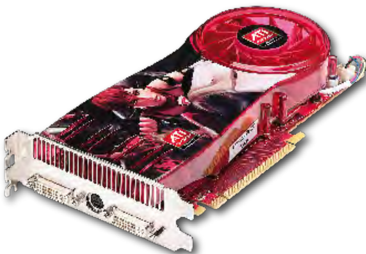
Figure 4. Carte graphique haut de gamme de ATI. Le processeur graphique qui prend place sur le modèle HD3870 dispose d'une puissance de calcul équivalente à celle d'une unité centrale moderne.
