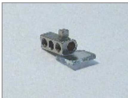
Et voilà le travail ! Le miroir, le coupleur d'axe et l'aimant, tous parfaitement assemblés.
