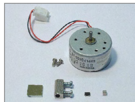
Tous les constituants de notre servo : le miroir, le coupleur d'axe, le capteur magnétique et le petit aimant.
