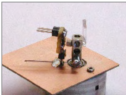
Le servo au grand complet y compris le capteur magnétique supporté par un petit PCB judicieusement positionné.
