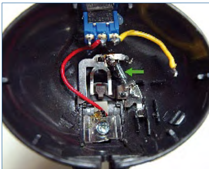
Figure 1. Une diode de suppression était montée en parallèle sur l'ampoule du phare.
