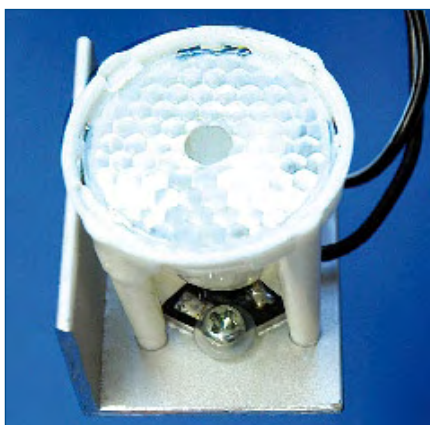
Figure 7. Module constitué par la LED sur la platine de support et l'optique vissées sur une cornière alu. La LED, isolée par des « rondelles » en plastique en U, est fixée par des écrous M3.
