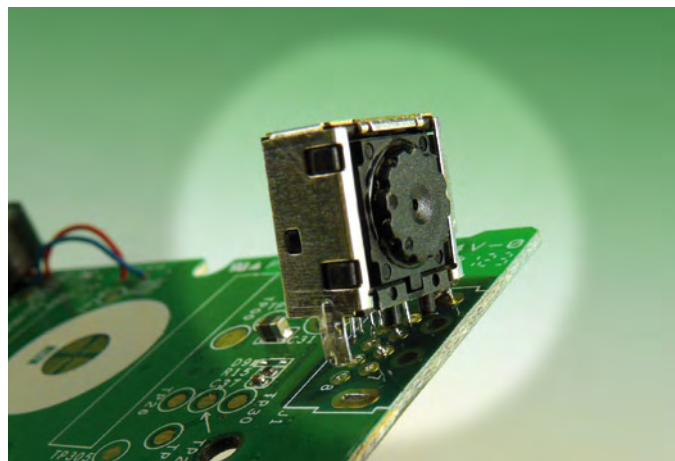
Figure 6. Les connexions du blindage du boîtier sont un peu plus opiniâtres.
