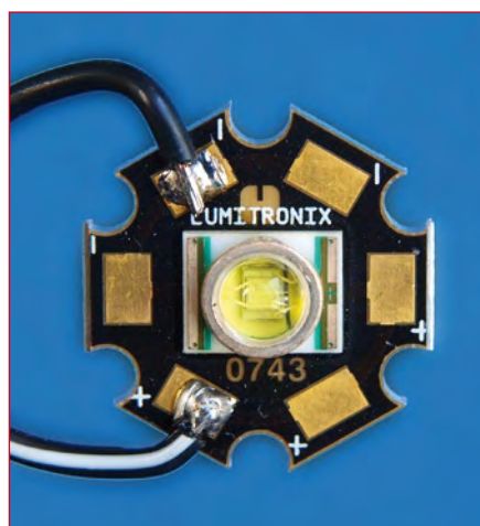
Figure 1. La DEL 3 W de Cree dont l'auteur s'est servi est un composant électronique particulièrement esthétique.
