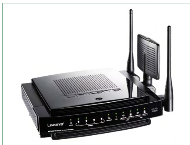
Trois antennes ! Un routeur WiFi bi-bande conforme la norme 802.11n MIMO. (Avec l'autorisation de Linksys)
