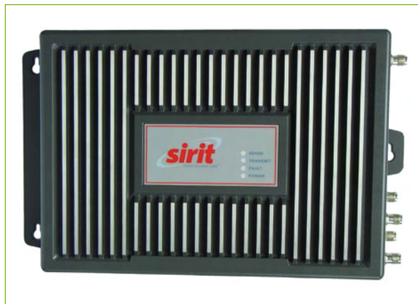
Figure 10. Lecteur d'EPC en UHF à longue portée de marque Sirit.
