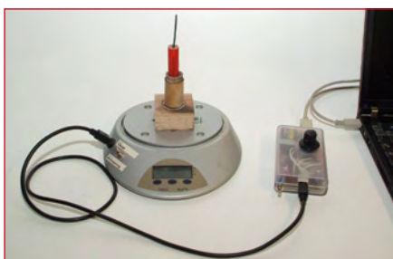
Figure 7. Le banc de poussée prêt à l'emploi.
