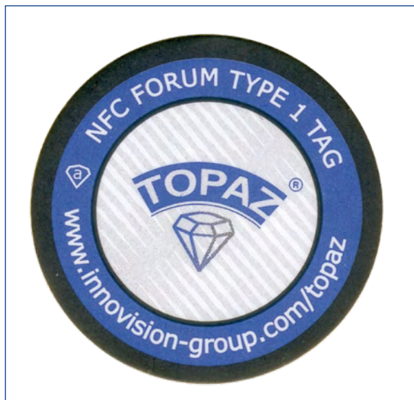
Figure 3. Aussi minces que du papier, les tags NFC « Topaz » d'Innovision (diamètre 28 mm).
