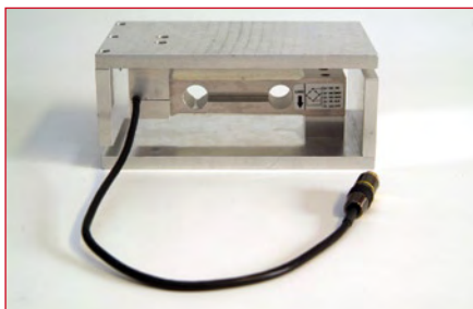
Photo 6. Dispositif pour des mesures dynamométriques dans un plan vertical et horizontal.
