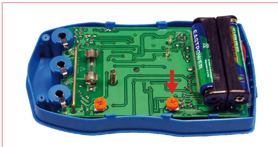
Figure 1. Intérieur d'un simple multimètre numérique dans la gamme de prix 25 € : le potentiomètre trimmer vers lequel pointe une flèche rouge permet de calibrer l'affichage.
