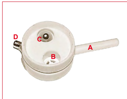
Figure 7. Le corps de pompe modifié, côté membrane. Tube soufflant (A), valve de soufflerie (B), valve d'aspiration (C) et le tube aspirant (D).
