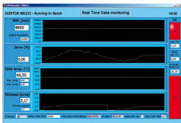
Figure 9. Le logiciel pour PC CBRMmonitor montre en direct l'évolution des paramètres importants du moteur.
