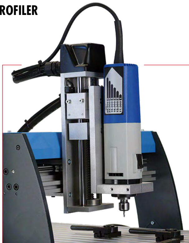
Figure 3. Le nouvel axe Z est plus robuste et plus facile à régler que son prédécesseur. De plus il possède une tête flottante. Le moteur monté ici sur l'axe Z est un IAC500 de Colibus.
