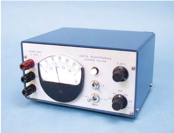
Figure 1. Le D030-1, fabriqué entre 1964 et 1970, possédait un galvanomètre à cadre mobile typique pour l'époque.
