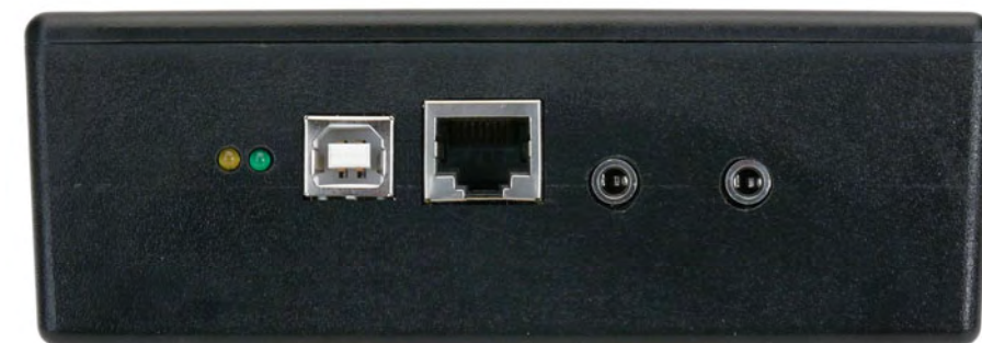
Figure 2. Voici l'unité d'atténuation. De gauche à droite, la LED jaune indique la communication avec le PC, la verte témoigne de la tension d'alimentation, à côté, le connecteur USB et celui pour RJ45 pour atteindre la boîte distante avec les boutons, ensuite la sortie du signal et enfin le raccordement pour casque.
