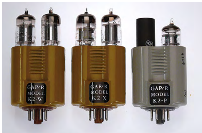
Amplis op K2-W, K2-X et K2-P de GAP/R. (Collection de l'auteur)
