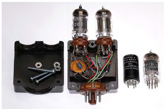
Ampli op C/50 d'Embre Electronics (ouvert par curiosité), tube « computer » de GAP/R et module « Airpax » A-175 DC-to-AC de GAP/R. (Collection de l'auteur)
