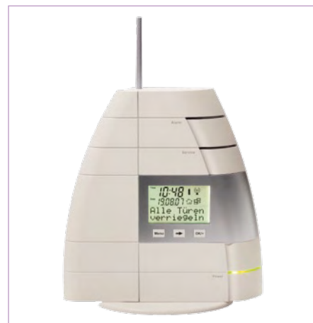
Figure 4. La centrale de technique du bâtiment est le cœur du système de domotique. Une variante sans fil avec connexion PC (photo : HomeMatic System de ELV).
