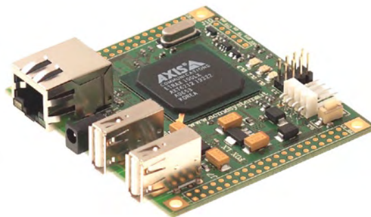
Figure 9. La carte FOX LX832 par Acme Systems. Cette carte aux dimensions de 66 x 72 mm possède un port Ethernet, deux ports USB 1.1, des E/S numériques, un port I 2 C, des ports série et parallèle, fonctionne sous Linux et coûte 139 €.
