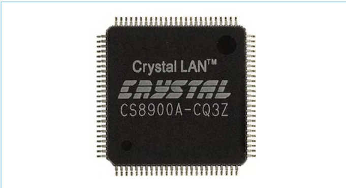
Figure 4. Toujours en vente, maintenant en version A, le contrôleur Ethernet Crystal LAN CS8900A.
