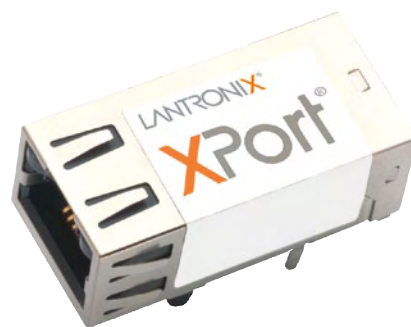
Figure 7. Difficile à croire, mais ce petit module contient un ordinateur capable d'exécuter Linux.
