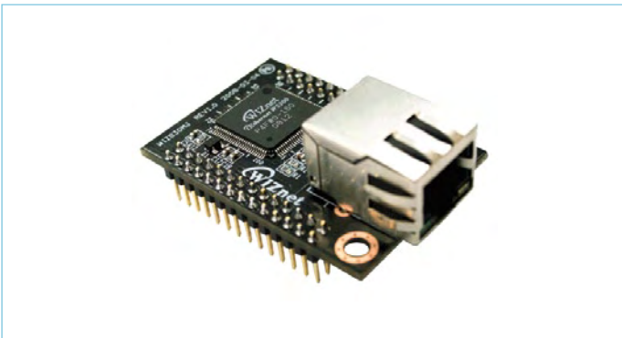
Figure 5. Le module WIZ 830MJ comprend non seulement un contrôleur Ethernet, mais aussi une pile TCP/IP matérielle.
