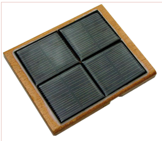
Figure 7. Disposition des modules solaires dans le prototype de l'auteur.
