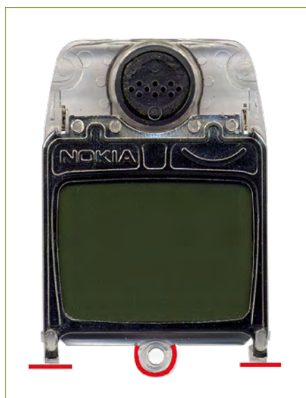
Figure 5. Sciez le support de matière plastique en vous guidant sur les lignes rouges de cette photo.
