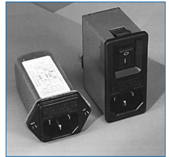
Exemple de filtre secteur standard. Il comporte une entrée secteur euro, un interrupteur marche/arrêt et un filtre efficace. Son enveloppe en métal doit être reliée au métal du boîtier.
