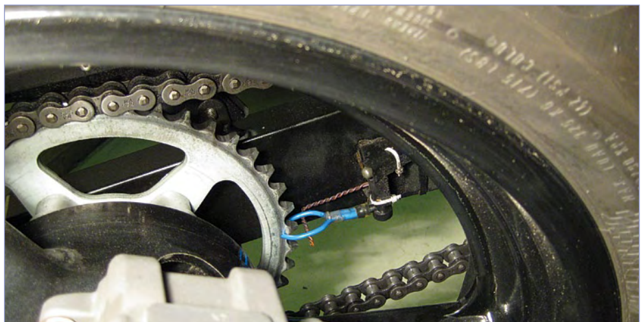
Figure 4. Au lieu de laisser tomber l'huile sur la chaîne et d'en répandre la majeure partie en roulant, celle-ci est déposée sur le bord du plateau.
