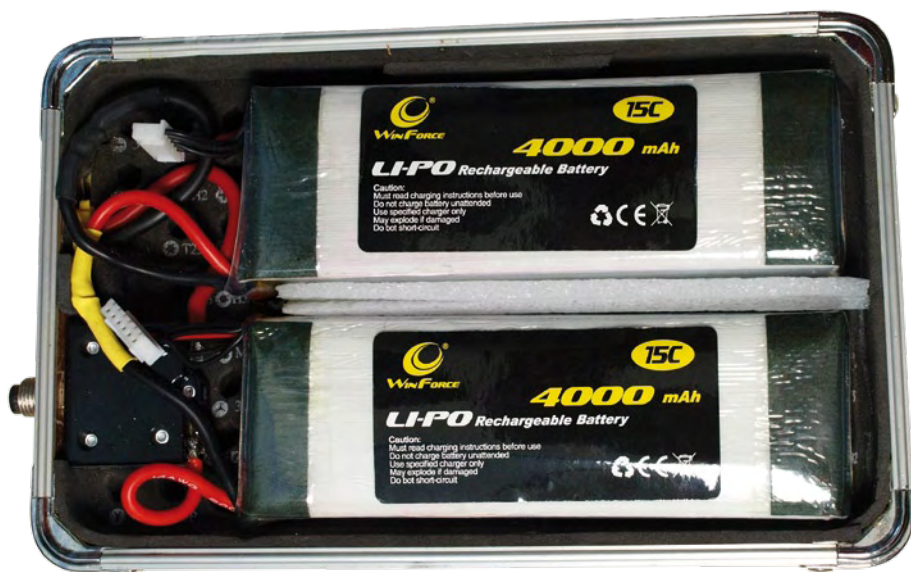
Figure 1. Deux accumulateurs Li-Po chinois 5s en série avec un fusible dans un boîtier d'aluminium et fournissant l'énergie nécessaire à l'assistance électrique d'un vélo.
