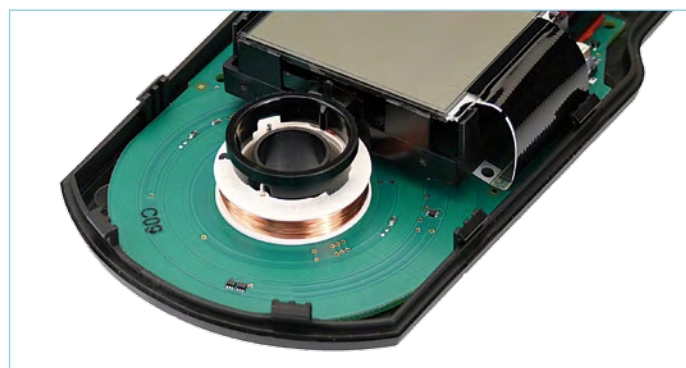
Figure 2 – Les détecteurs de conduits Bosch et Skil ont recours à une bobine orientée vers le mur pour détecter plus exactement les métaux. Les pistes imprimées autour constituent le capteur capacitif pour la détection du bois.
