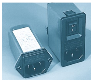
Un filtre secteur standard avec une entrée secteur euro, un interrupteur marche/arrêt et un filtre efficace. Son enveloppe en métal doit être reliée au métal du boîtier.
