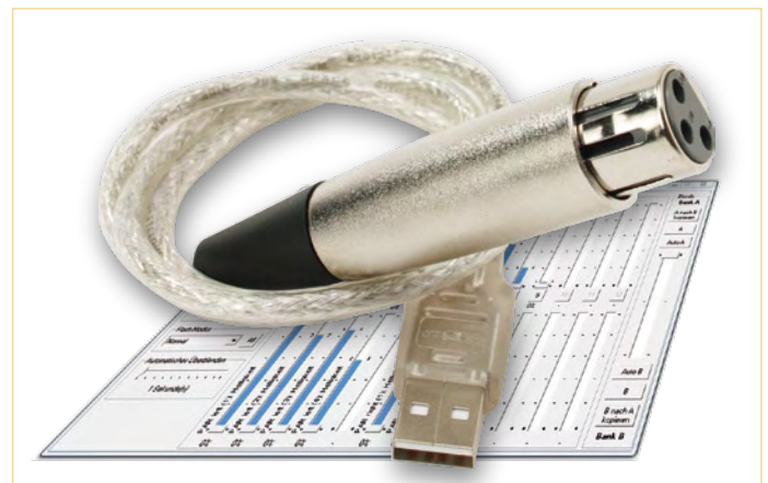
Figure 1 – L'interface DMX-USB d'Elektor (circuit dans la fiche XLR !) et le logiciel gratuit DMXControl transforment le PC en pupitre d'orgue lumineux [3].
