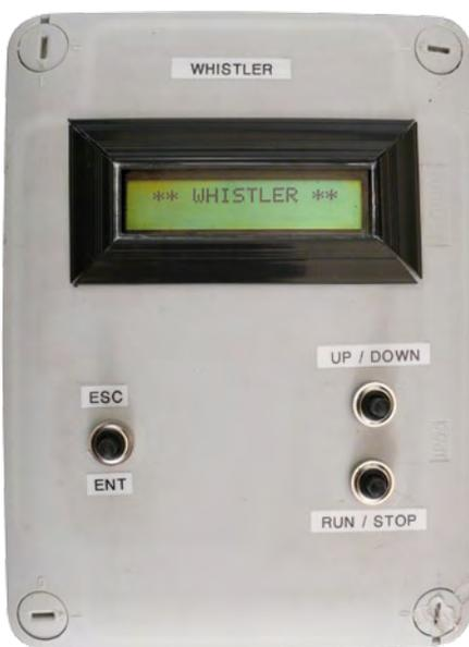
Ce dispositif permet de générer des bips sonores à des intervalles de temps réguliers et choisis pour cadencer des entraînements de course sur piste. Chaque intervalle de temps est marqué par un bip et la fin d'un test est signalée par un double bip. Deux types de tests sont permis : Les tests 1 à 4 proposent un certain nombre
